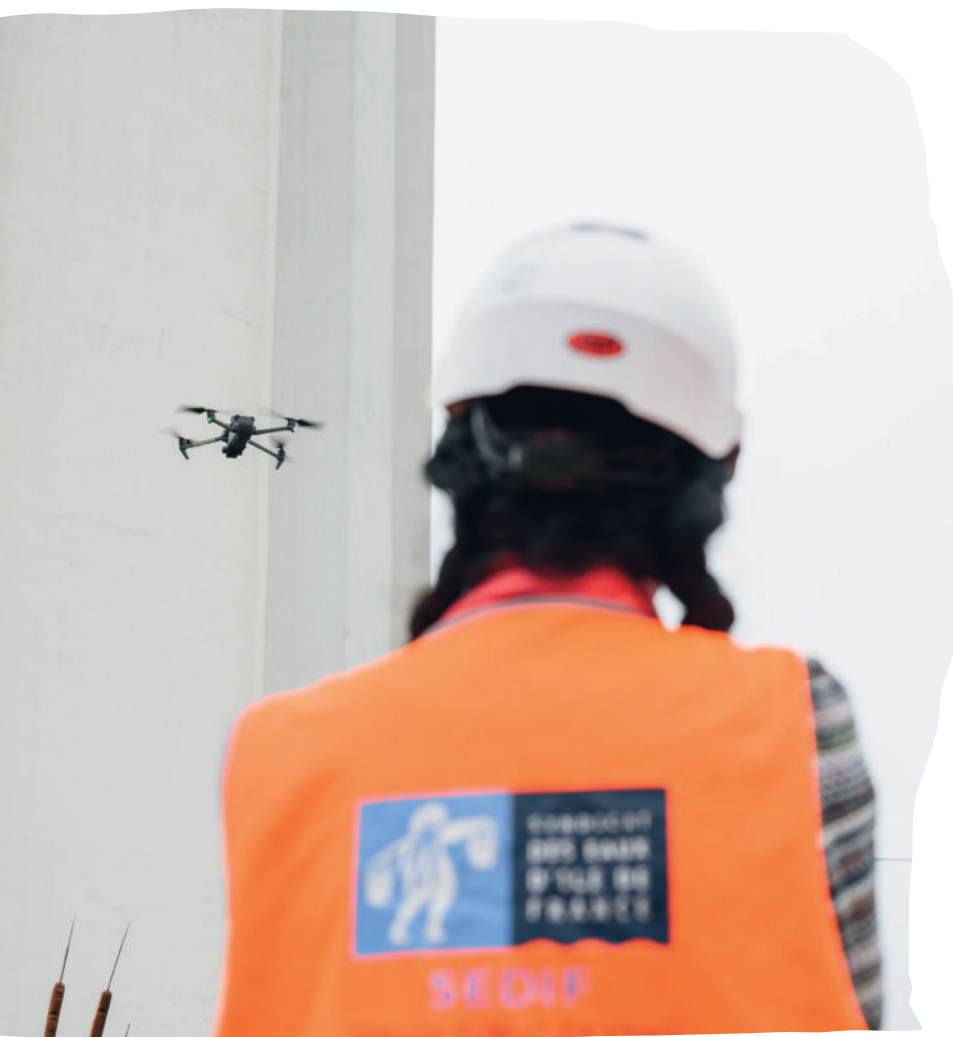
Diagnostic par drone du réservoir de Champigny-sur-Marne - Cœuilly
