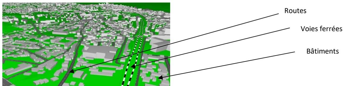
Figure 12 : Représentation 3D du modèle de calcul acoustique
