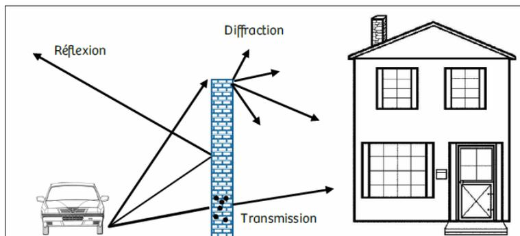
Figure 8 : Effet d'un obstacle sur la propagation du bruit
