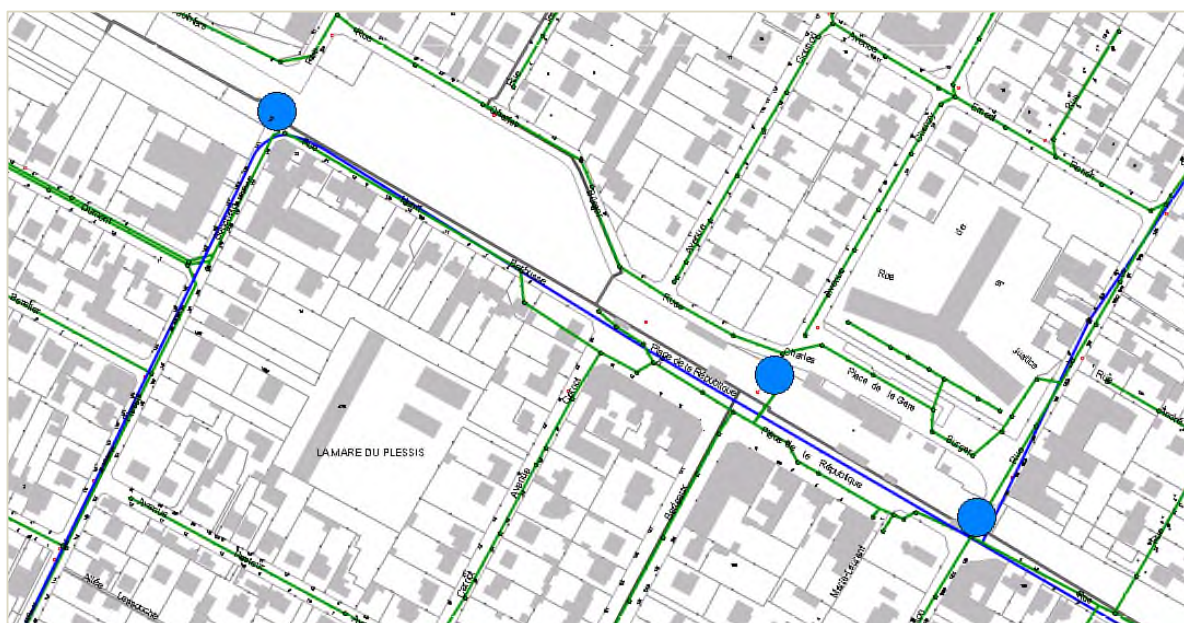
3 Postes EP, récupérant les eaux de ruissellement des passages piétons sous les voies ferrées de la Gare.
